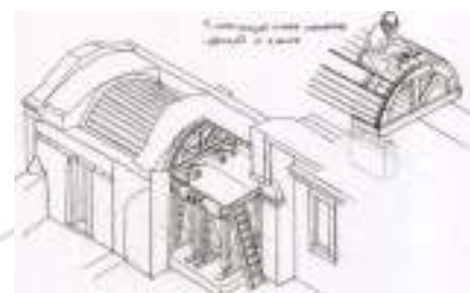
Fases da reconstrução da abóbada da Capela -Mor
