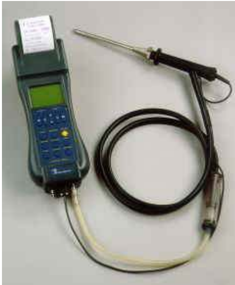
Analizador de gases
