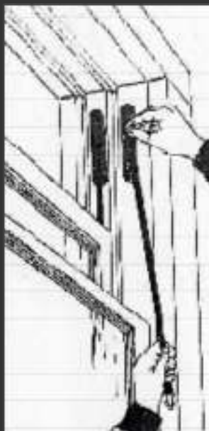
Fazer um entalhe na armação da janela, para receber o corpo da mola
