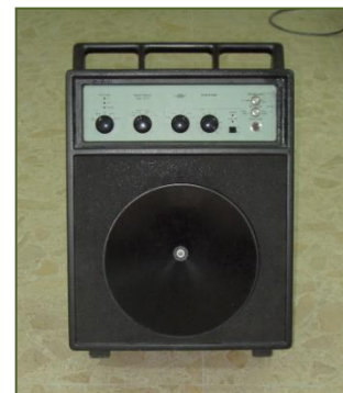
Fonte de ruídos aéreos (direccional)
