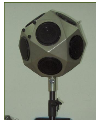
Fonte de ruídos aéreos (omnidireccional)
